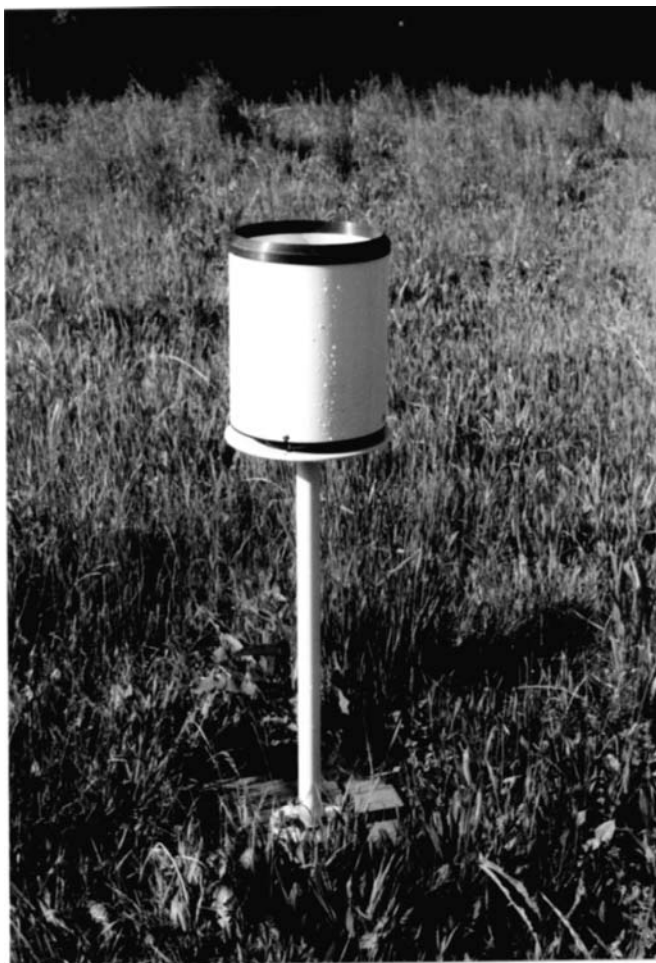
Obr. 2-14 srážkoměr MR3H - celkový pohled na srážkoměr se stojanem a dlaždicí.
