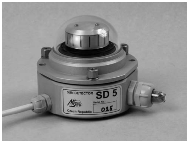
Obr.2-22 - Pohled na detektor SD5 se stínícím krytem
