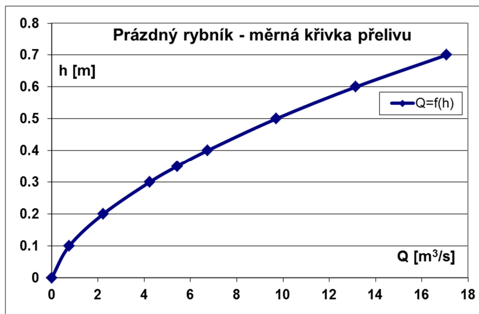
Obr. 12 Měrná křivka přelivu – Prázdný rybník
