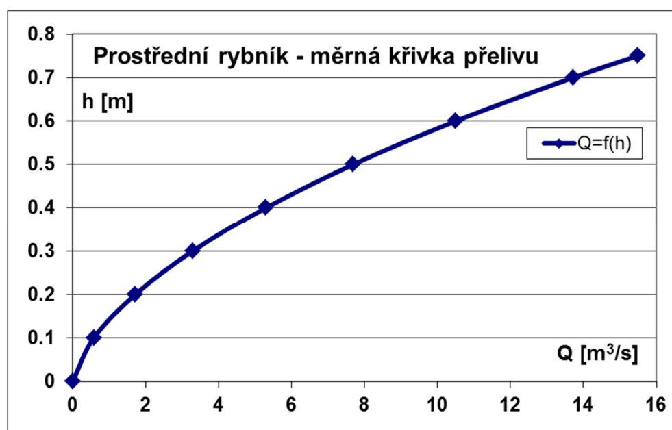
Obr. 11 Měrná křivka přelivu – Prostřední rybník
