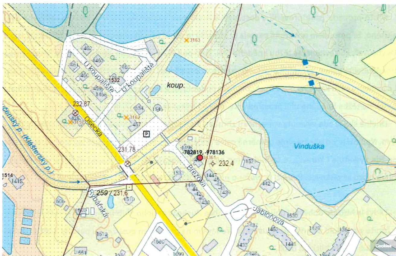
Obr. č. 1: Výřez z mapy Důlní díla a poddolování s vyznačením polohy šetřeného důlního díla – červený bod (bez měřítka).
