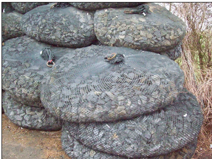
Vaky Kyowa vyplněné kamenivem
